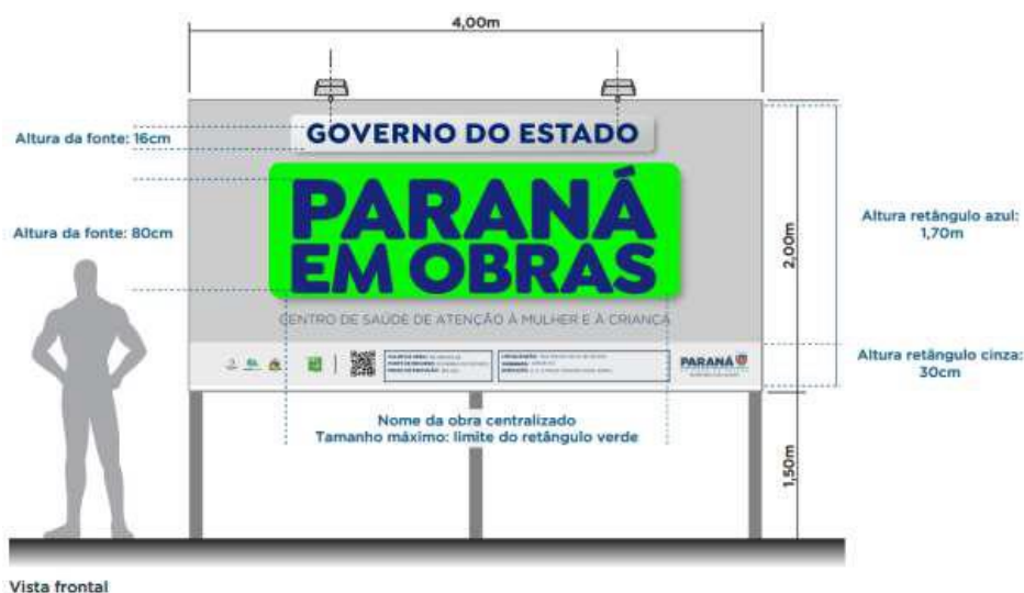
Figura 3 – Placa de obra padrão do Governo do Estado
